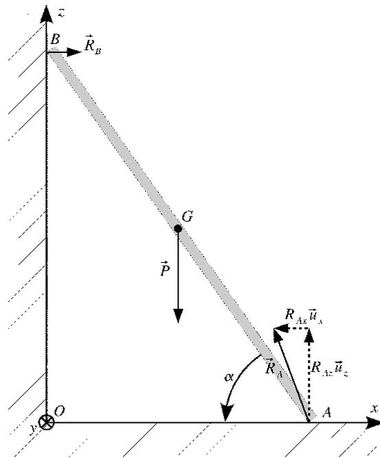
Les théorèmes du centre d'inertie et du moment cinétique (cf. § IX) suffisent à déterminer entièrement le mouvement d'un solide. Pour que l'échelle soit immobile, il faut que la somme des forces extérieures et la somme des moments de ces forces par rapport à un point fixe soient nulles. Puisqu'il y a équilibre,  $A$  peut être choisi comme point fixe de manière à éliminer  $\vec{R}_A$  dans le théorème du moment cinétique. On a donc
