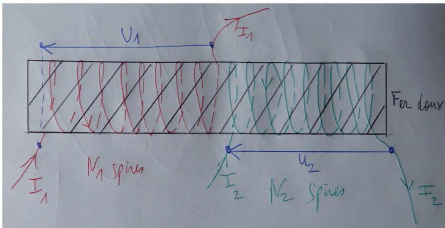
Pour assurer ce couplage, on peut par exemple les enrouler côte à côte autour d'une même barre de fer doux<sup>\*7</sup>. Sans rentrer dans les détails, ce dernier permet de canaliser le champ magnétique produit par les bobines. Le flux du champ magnétique est donc quasiment le même à travers une section de l'une ou l'autre bobine. Le couplage entre elles est alors quasi maximal et  $L_{\alpha,\beta}^2 \approx L_\alpha L_\beta$ .
